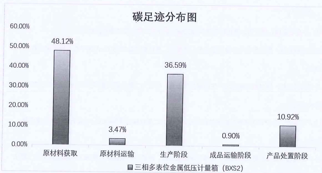
图 5.2.1.2 三相多表位金属低压计量箱 (BXS2) 生命周期阶段碳排放分布图
