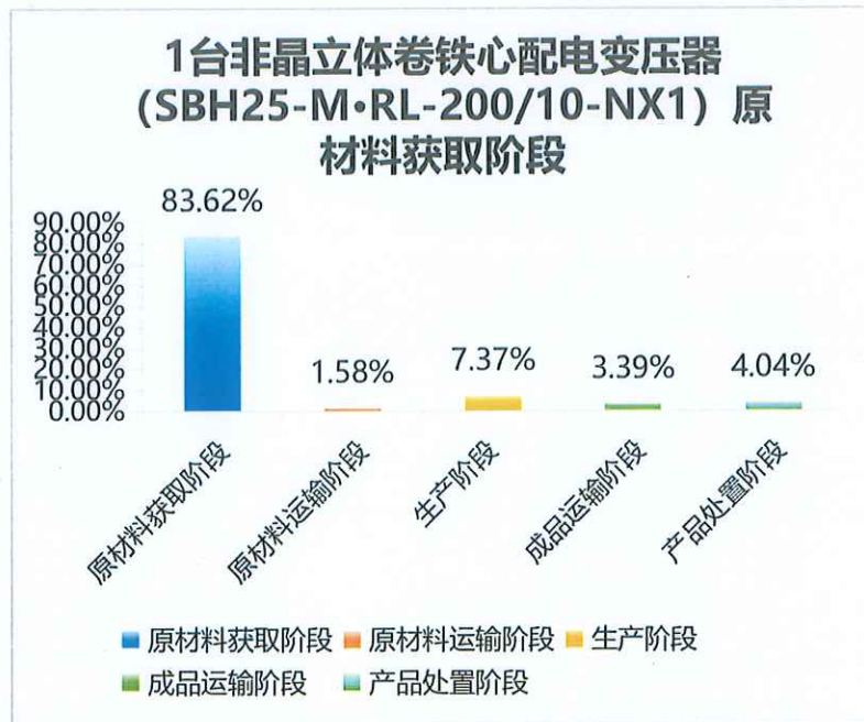
图 5.2-2 1台非晶立体卷铁心配电变压器 (SBH25-M·RL-200/10-NX1) 生命周期阶段碳排放分布图
