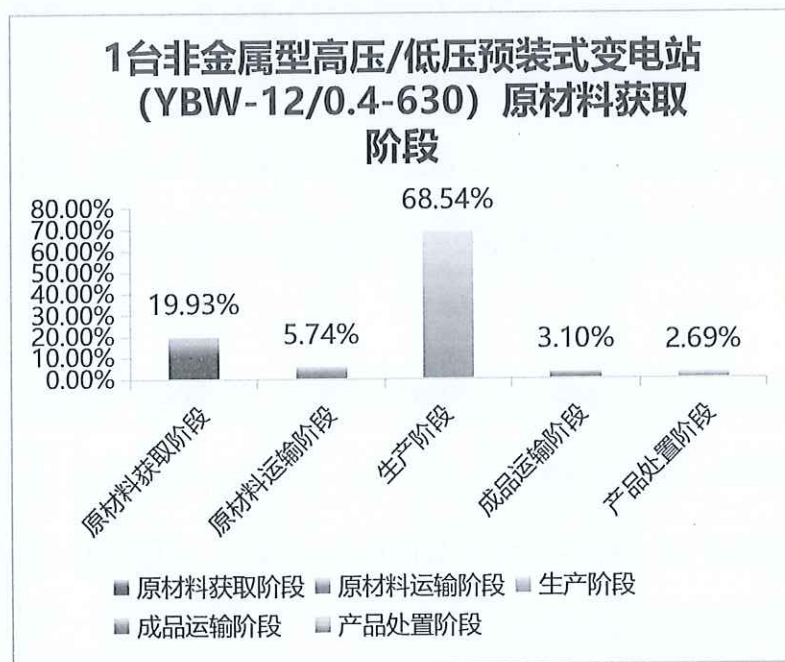
图 5.2-2 1 台非金属型高压/低压预装式变电站（YBW-12/0.4-630）生命周期阶段碳排放分布图
