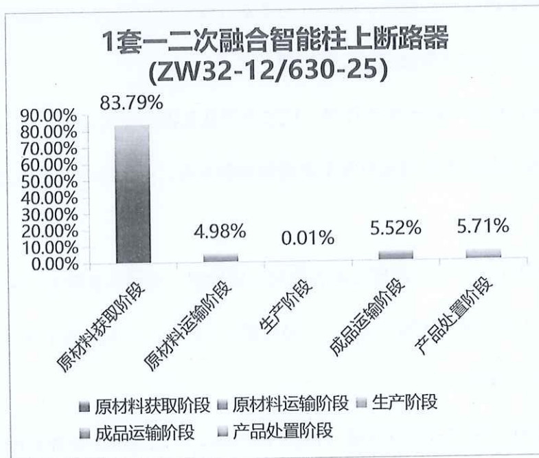
图 5.2-2 一套一二次融合智能柱上断路器 (ZW32-12/630-25)
