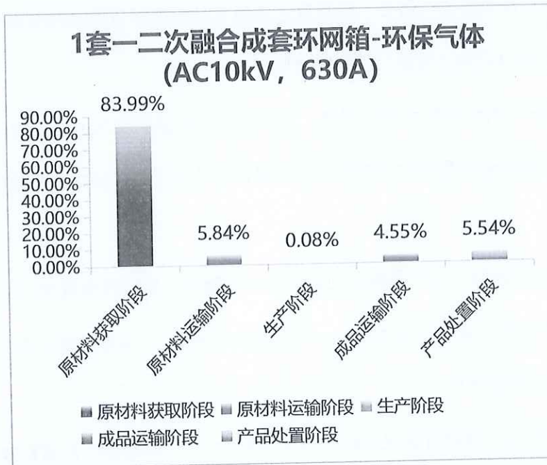
图 5.2-2 一套一二次融合成套环网箱-环保气体 (AC10kV, 630A)
