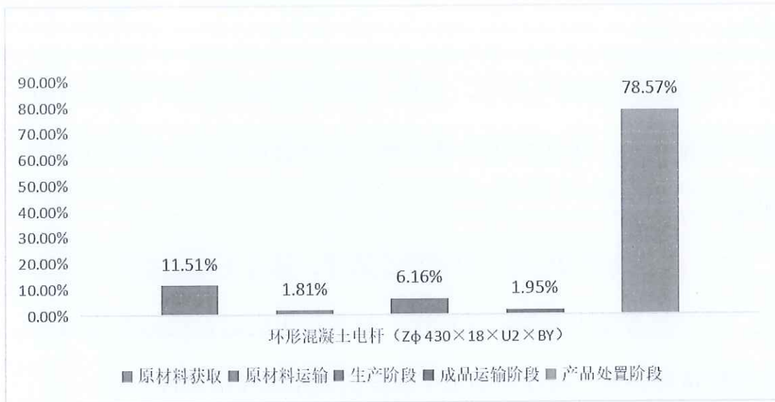
图 5.2.2 环形混凝土电杆 Zφ 430×18×U2×BY (生命周期阶段碳排放分布图)
