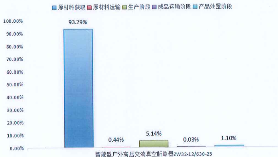
图 5.2.12-2 一二次柱上断路器深度融合 ZW32-12/T630-20 生命周期阶段碳排放分布图
