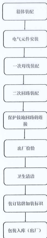
落地计量柜装配工艺流程图
