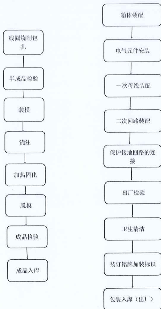
低压互感器生产流程图
