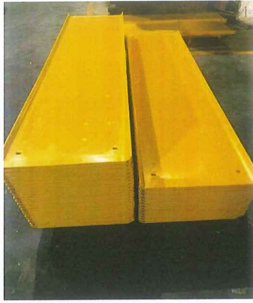
电缆防火隔板
