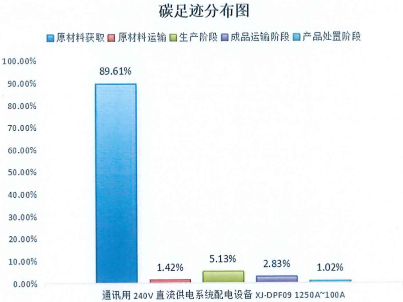
图 5.2.8-2 通讯用 240V 直流供电系统配电设备 XJ-DPF09 1250A~100A 生命周期阶段碳排放分布图
